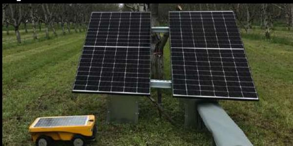
Le panneau solaire monté sur le VITIROVER permet au robot de travailler jusqu'à 6 heures par jour, selon l'ensoleillement.
